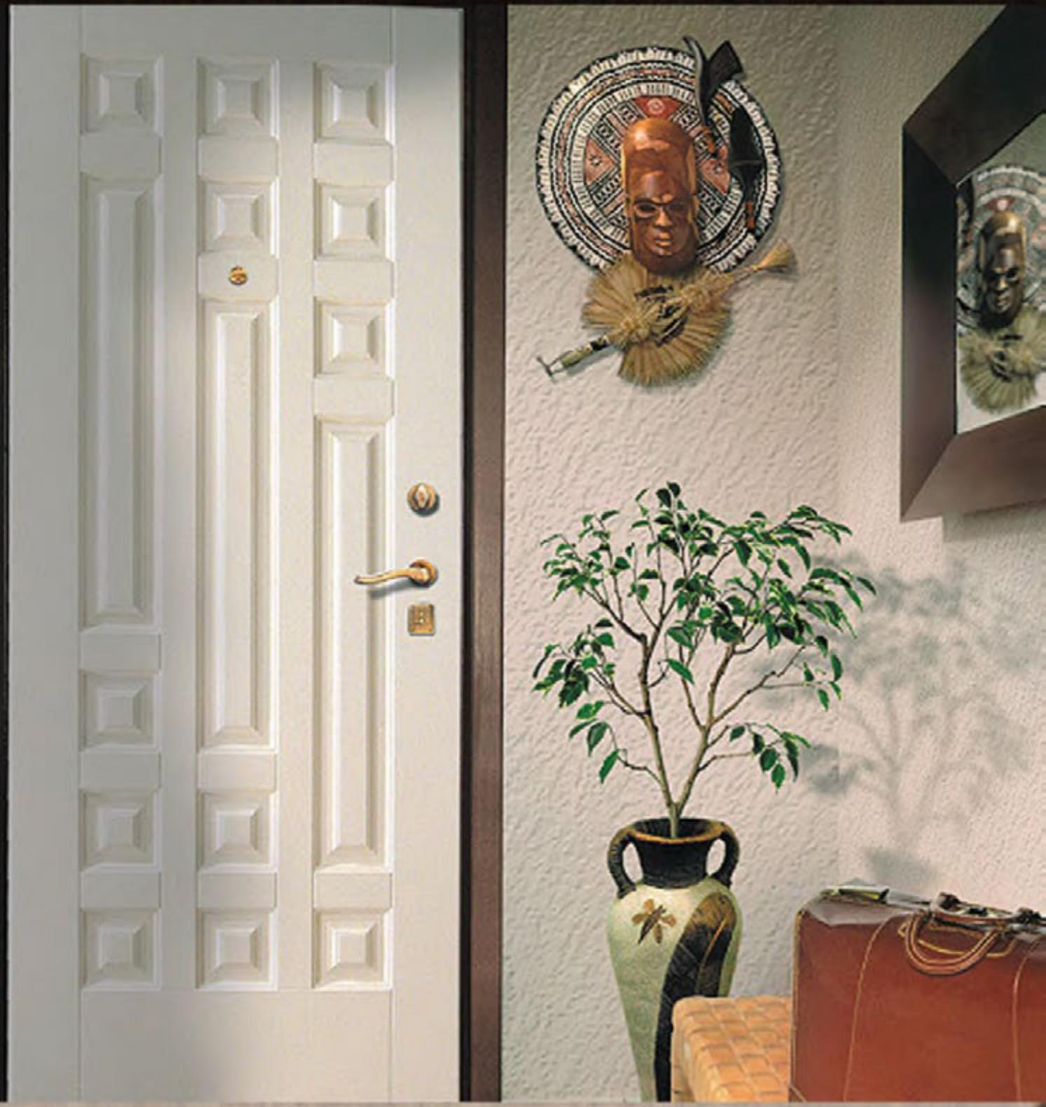
Дверные накладки серии "С" изготавливаются из МДФ и покрываются пленкой ПВХ методом горячего прессования на мембрально-вакуумном прессе. Особенностью накладок данной серии являются геометрические рисунки, фрезерованные двумя видами фрезы.
