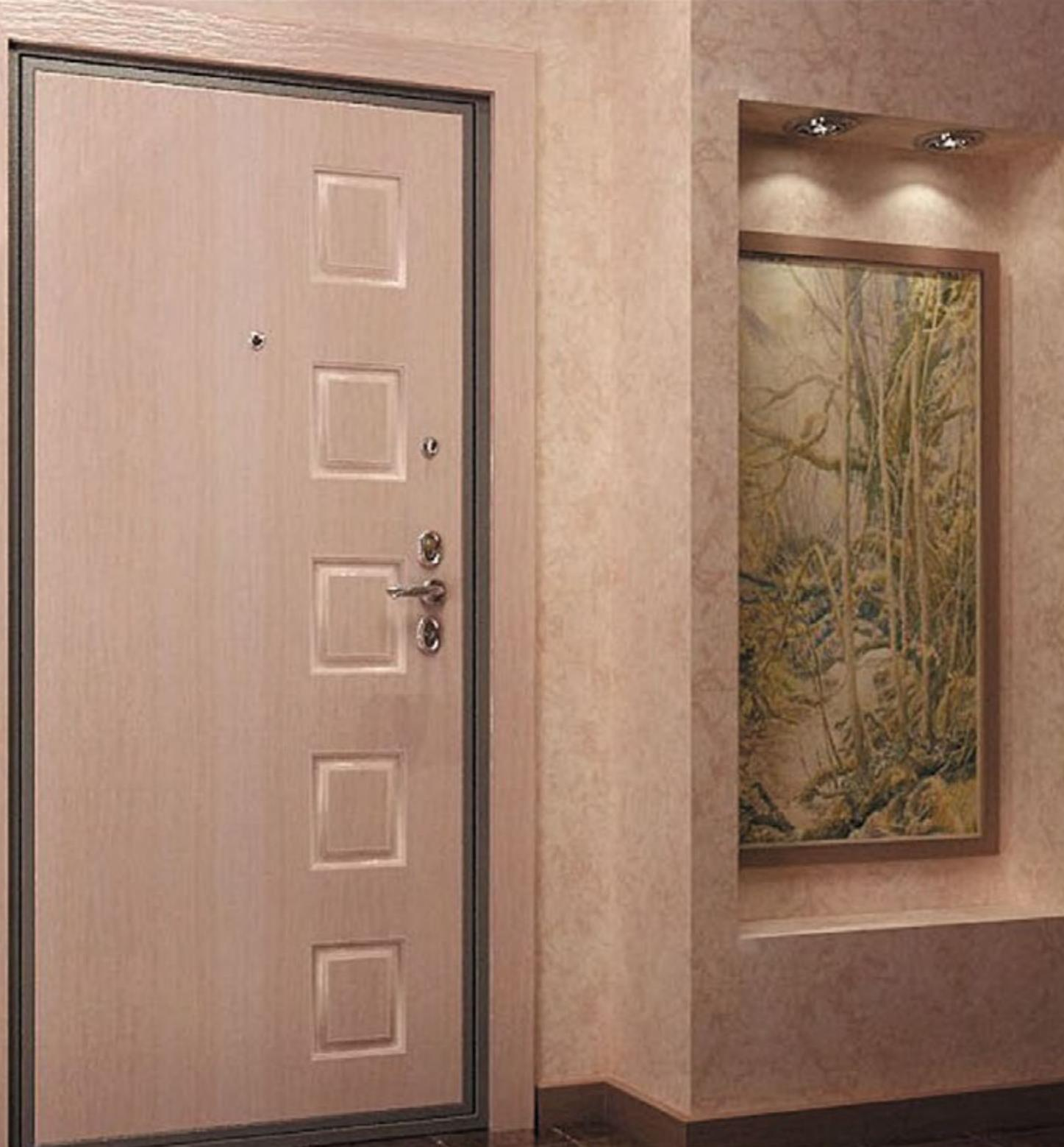
Дверные накладки серии "А" изготавливаются из МДФ и покрываются пленкой ПВХ методом горячего прессования на мембранны-вакуумном прессе. Особенностью накладок данной серии являются геометрические рисунки, фрезерованные одним видом фрезы.
